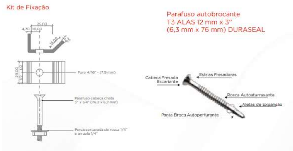
Figura: Recomendação do sistema de fixação
